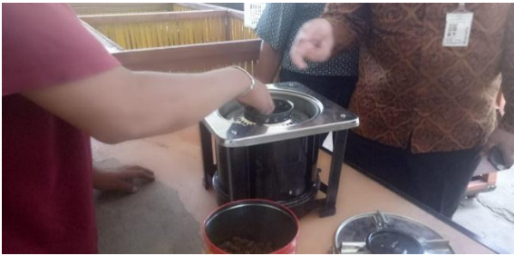
Gambar 3. Ujicoba kompor bahan bakar pelet
