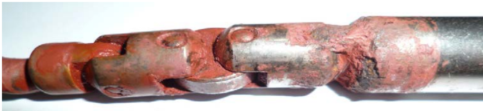
Gambar 3. Shaft ulir dan kopling dalam kondisi pemakaian 6 bulan
