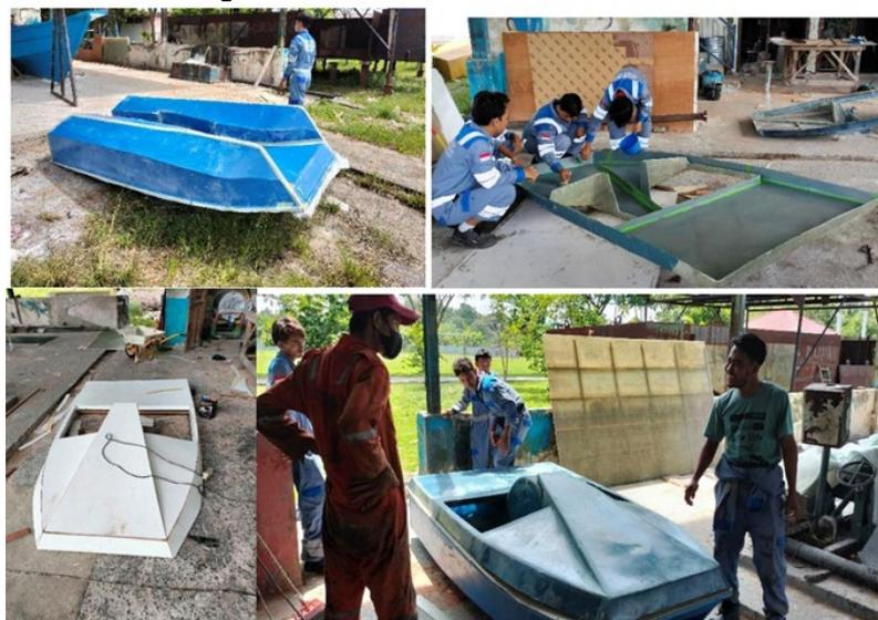
**Gambar 7 Proses pembuatan bagian atas Sepeda Air**
