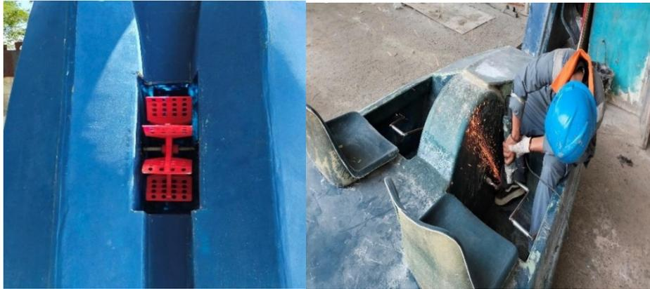
**Gambar 8. Pemasangan sistem penggerak dan kemudi sepeda Air**
