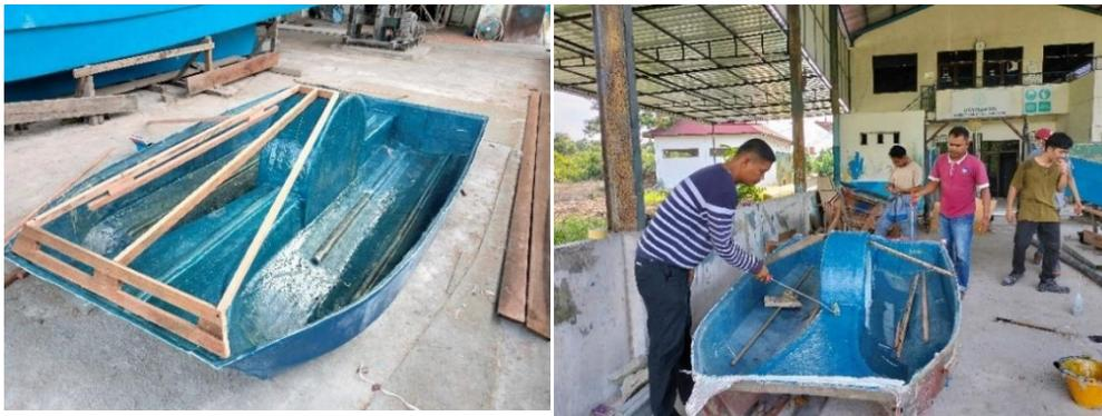
**Gambar 6 Cetakan sepeda Air**
