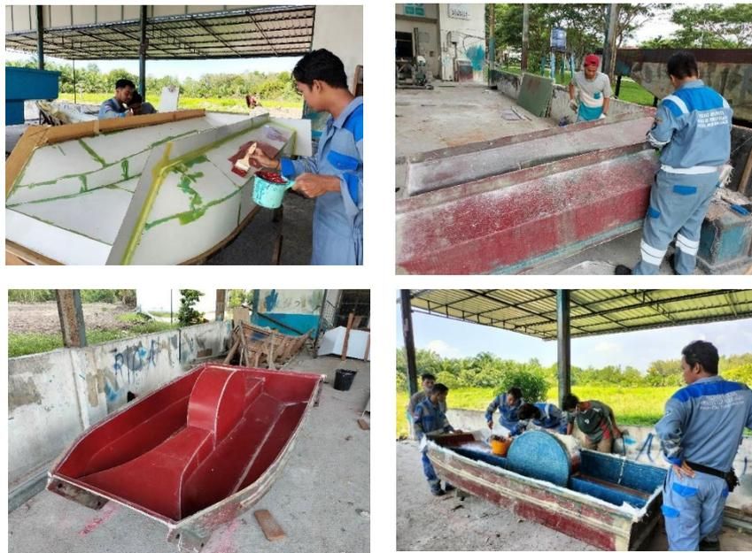
**Gambar 5 Cetakan sepeda Air**
