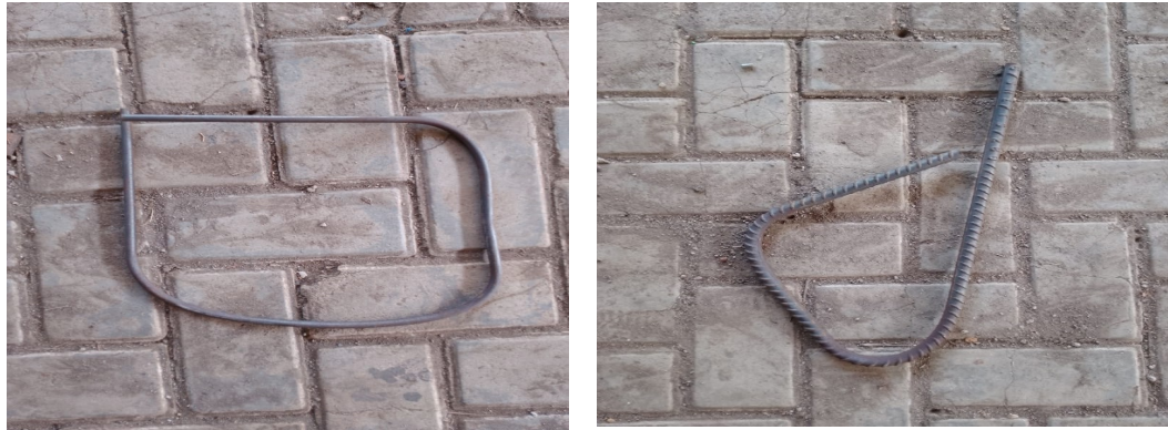
Gambar 12. Hasil Penekukan Besi Beton
