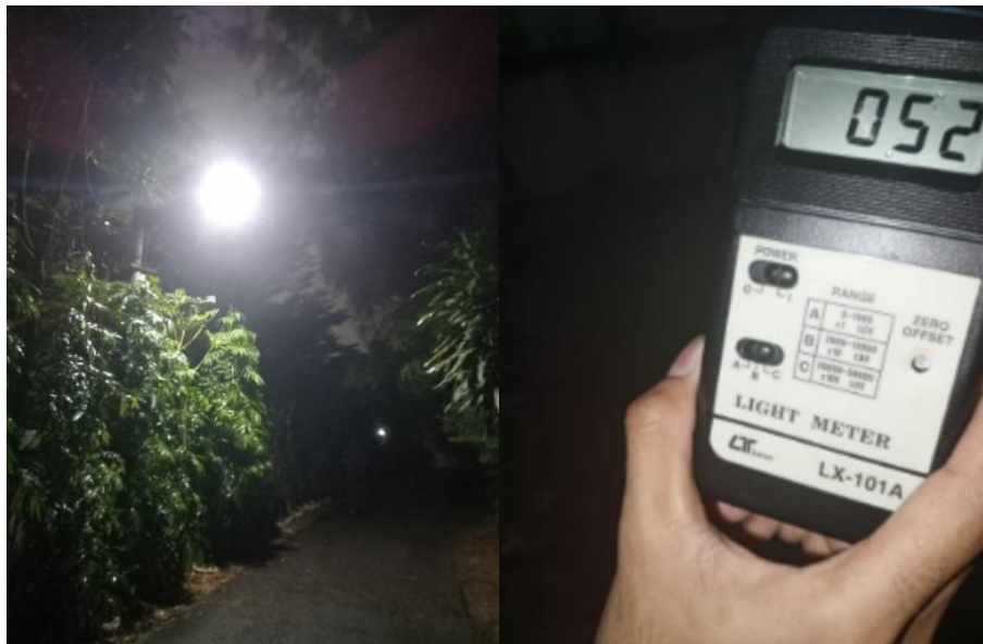
Gambar 3 Pengujian Kuat Cahaya Lampu Panel Surya
