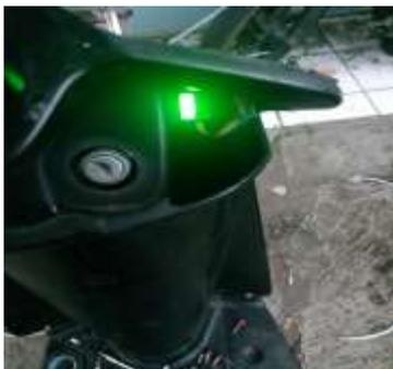
Gambar 4.5 Penempatan Fingerprint
