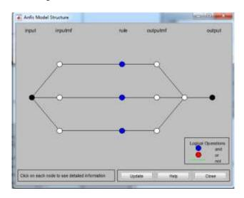
Struktur Fis yng digunakan terdiri dari 1 input, 3 membership function input, 3 rules, 3 membership function output, dan 1 output.
