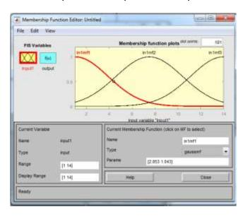
Gambar membership function pada Matlab. Nilai parameter nya dapat diubah sesuai dengan karakteristik Fis yang kita inginkan.
