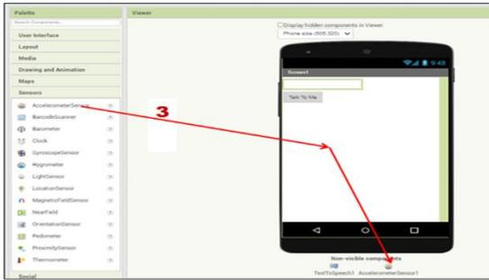
Gambar 6 Penyisipan *Palette AccelerometerSensor*
