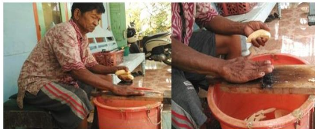
Gambar 1. Pengirisan Pisang Dengan Alat Pengiris Manual
