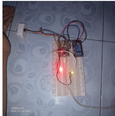
Gambar 16. Kedua Lampu LED menyala secara otomatis menggunakan PIR
