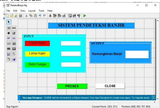
Gambar 8 Desain GUI Sistem pendeteksi banjir
