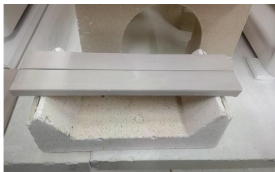
Gambar 5. Pembakaran Benda Uji Bending
