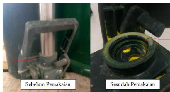
Gambar 1. Dudukan Pompa Canister sebelum dan sesudah Pemakaian
