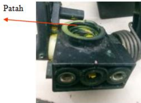
Gambar 3. Dudukan Piston Canister yang sudah Mengalami Patah
