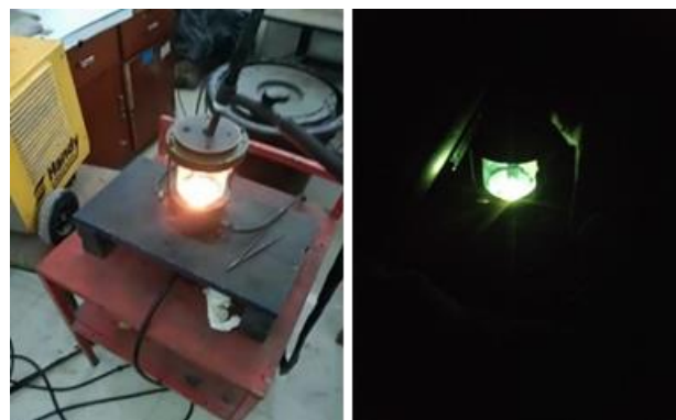
Gambar 5. Proses Peleburan Dengan Single Arc Melting Furnance Sumber : (Dokumen pribadi)
