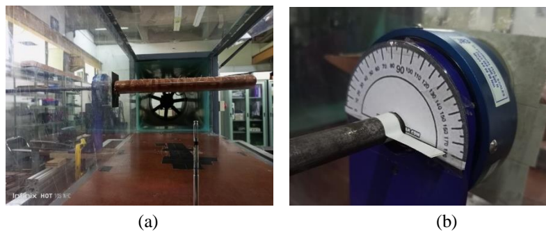
Gambar 6. (a) Terowongan angin dengan kecepatan angin 7,2 m/s dan (b) Sudut serang airfoil
