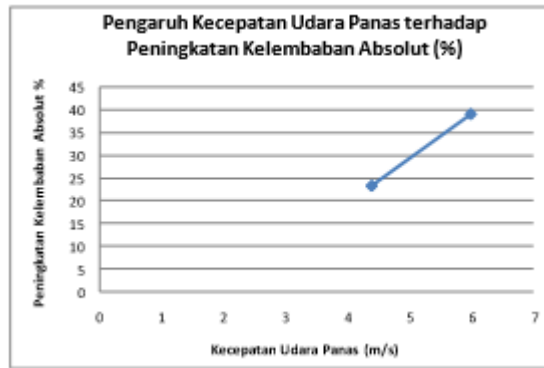
Gambar 5. Pengaruh Kecepatan Udara Panas terhadap Peningkatan Kelembaban Absolut
