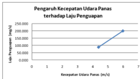
Gambar 6. Pengaruh Kecepatan Udara Panas terhadap Laju Penguapan
