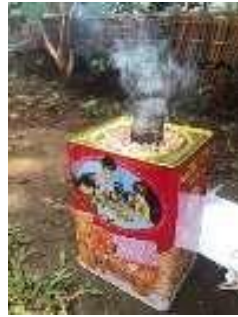
Gambar 1. Proses pembakaran serbuk gergaji kayu hingga menjadi arang
