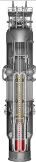
**Gambar 1.** Skema modul reaktor iPWR NuScale [12].
