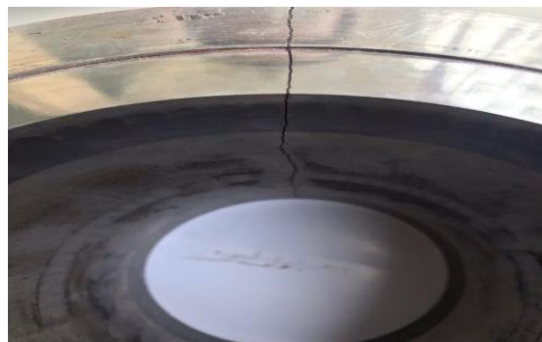
Gambar 1. Lokasi Retak dari Sisi Dalam
