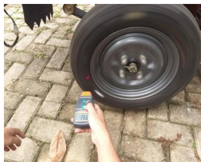
Gambar 4. Pengujian Kecepatan Putaran Roda Menggunakan Alat Ukur Tachometer
