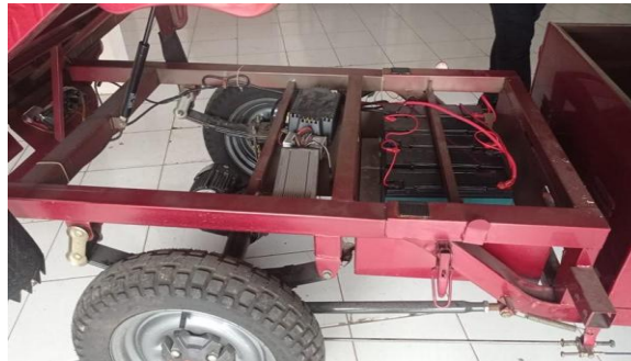
Gambar 2. Mobil Listrik Hasil Modifikasi Beserta Komponennya
