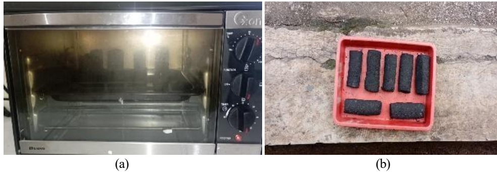
Gambar 5. Proses pengeringan briket: (a) Pengeringan briket molase dan kombinasi menggunakan oven 100 °C; (b) Pengeringan briket tapioka dengan sinar matahari
