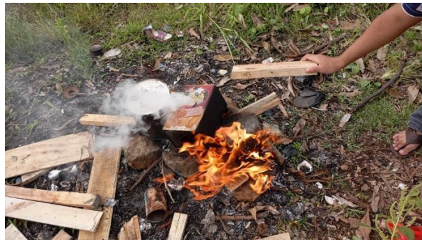
Gambar 1. Proses karbonisasi tempurung kelapa dalam kaleng tertutup menggunakan tungku pembakaran
