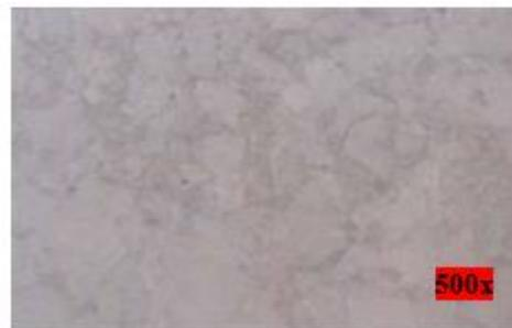
Gambar 4.23. Pengamatan pada titik 6 terlihat struktur ferrit yang dominan dan perlit serta bainit sedikit.
