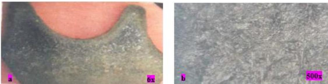
Gambar 4.16. Bahan uji yang akan diamati (a), pengamatan pada titik 1 terlihat struktur martensit halus (b).
