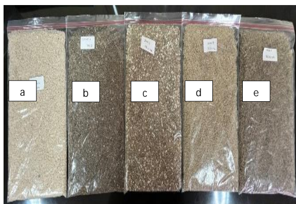
Gambar 1. Hasil kompon polimer (a) PA, (b) rPA, (c) rPA 50 (d) rPA 25 (e) rPA 75
