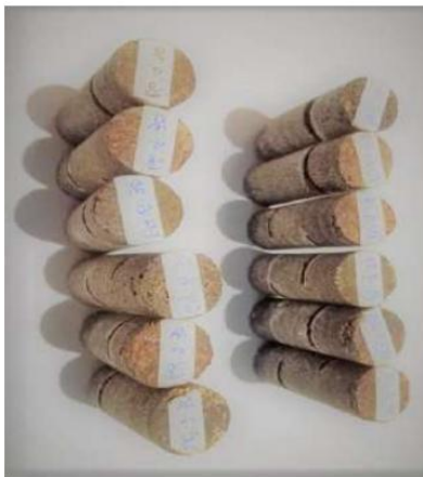
Gambar 1. Spesimen uji geser Komposit kanvas rem berbahan epoksi/serbuk PKS pada berbagai variasi komposisi dan ukuran partikel
