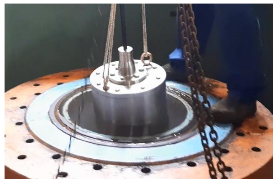
Gambar 11. Proses input dummy canister ke dalam pressure chamber
