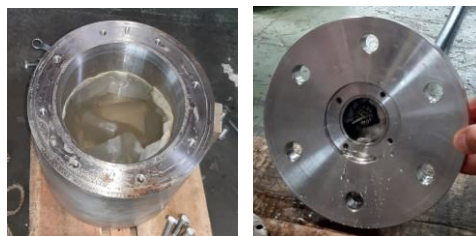
Gambar 14. Kebocoran pasca pengujian
