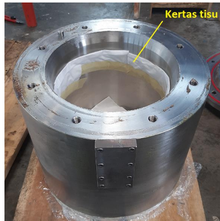
Gambar 8. Pemasangan kertas tisu pada silinder canister
