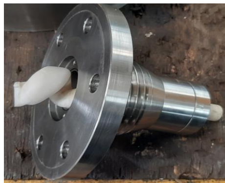
Gambar 16. Kondisi cone connector dan batang teflon pasca pengujian ulang
