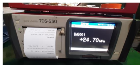
Gambar 12. Instrumen data logger Ketika tekanan mencapai 24,70 MPa.
