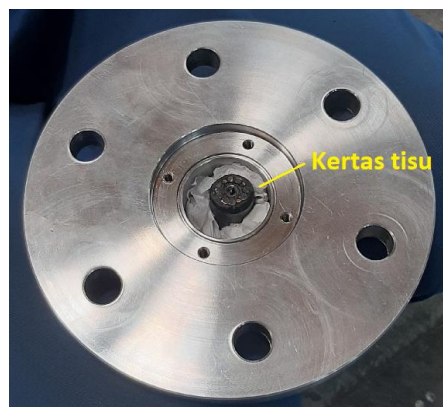
Gambar 9. Pemasangan kertas tisu pada cone connector
