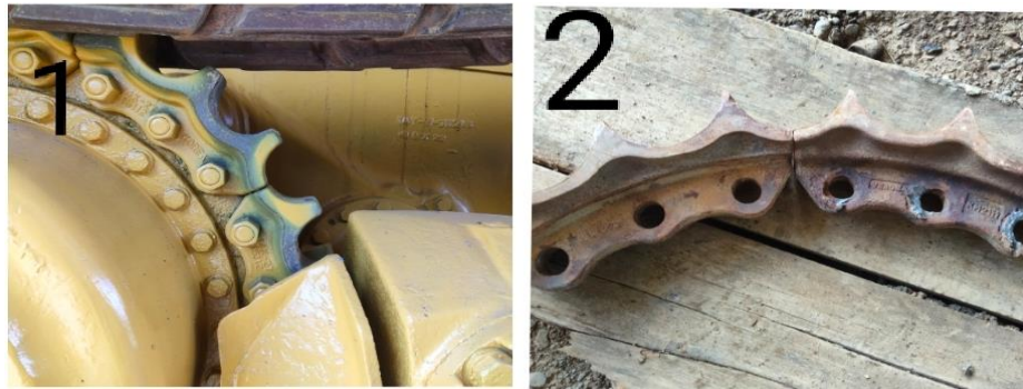
Gambar 1. segment sprocket baru (1), dan yang lama (2)
