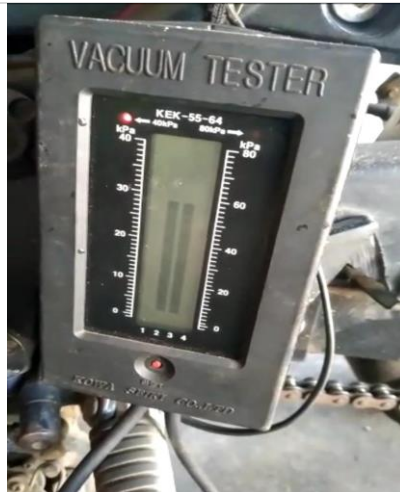
Gambar 11. Hasil pengukuran karburator setelah sinkron/sejajar (sesuai antara karburator di silinder 1 dan silinder 2)
