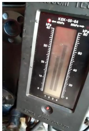
Gambar 10. Kondisi Karburator tidak sinkron
