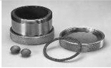
Gambar 1. Bola giling dan wadah penggilingan [5]
