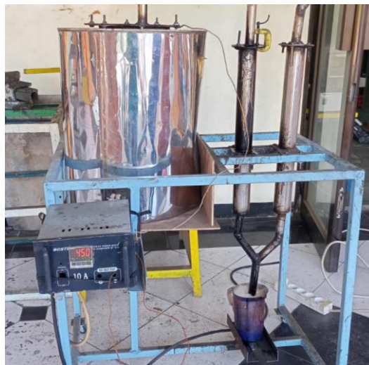
Gambar 2 Proses Pirolisis Serbuk Kayu Jati
