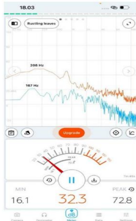
Gambar 7. Nilai kebisingan saat katup menutupi kedua pipa aliran
