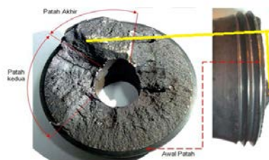
Gambar 5. Patah akhir membentuk sudut 45°
