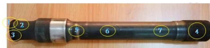
Gambar 2. Bolt Turbine No. mengalami crack seperti ditunjukkan pada lingkaran kuning.
