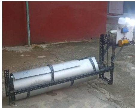
Gambar 3. Hasil Perancangan PLTPH.
