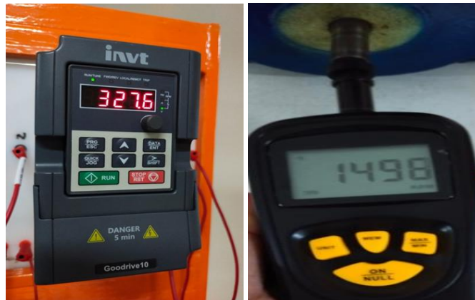
Gambar 5. Hasil ukur Tegangan dan RPM pada trainer
