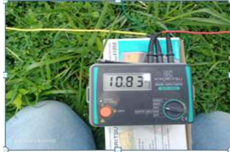
Gambar 5. Pengukuran Pentanahan Peralatan Listrik tegangan Tinggi
