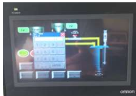
Gambar 11. Tampilan HMI masukan counter.
