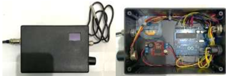
Gambar 3. Hasil rancangan alat panel kontrol.
