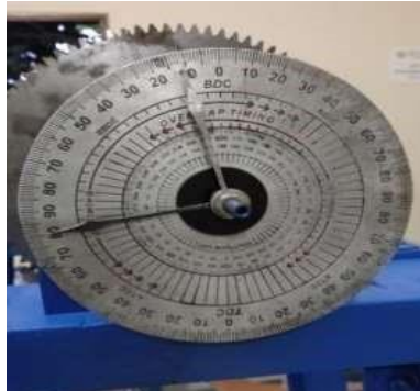
Gambar 3.9 pengujian impact charpy sudut awal 80 0 [Laboratorium Teknik mesin Universitas Pamulang]
