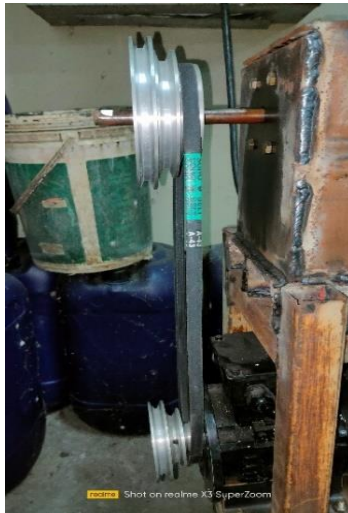
Gambar 4.4 Pertemuan pully ( d_1 ) tingkat 1 dan pully ( d_2 ) tingkat 1 (Sumber. Dokumen pribadi)
