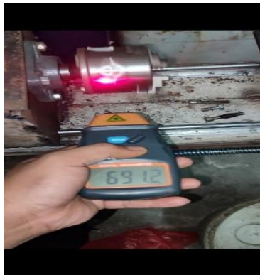
Gambar 4.8 Kecepatan putaran pada persilangan pully tingkat 1 (Sumber. Dokumen pribadi)
