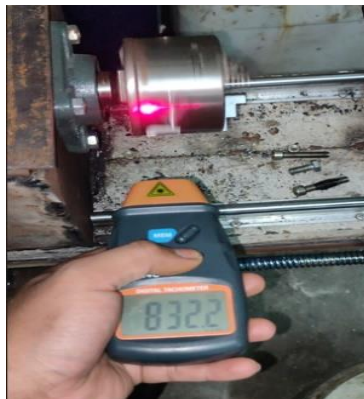
Gambar 4.9 Kecepatan putaran pada persilangan pully tingkat 2 (Sumber. Dokumentasi pribadi)
