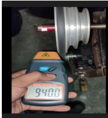
Gambar 4.10 Kecepatan putaran pada persilangan pully tingkat 3 (Sumber. Dokumentasi pribadi)
