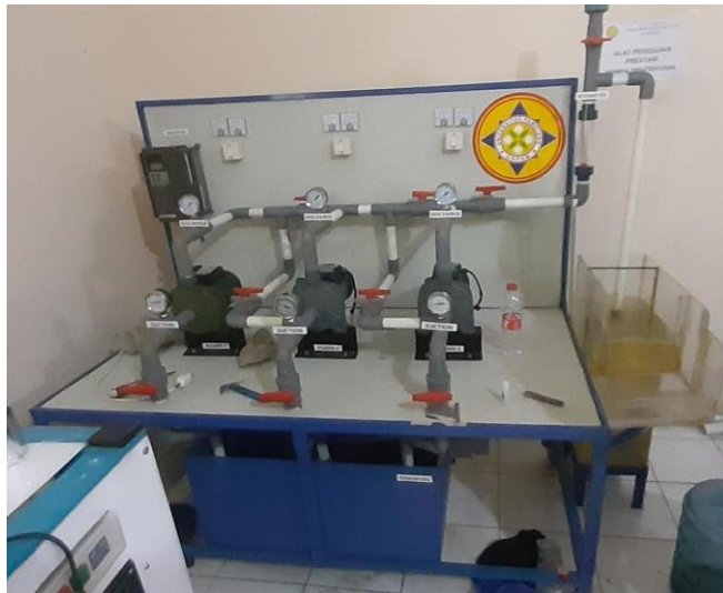
Gambar 3. 1 alat uji pompa sentrifugal Sumber: (Dokumen Pribadi)
