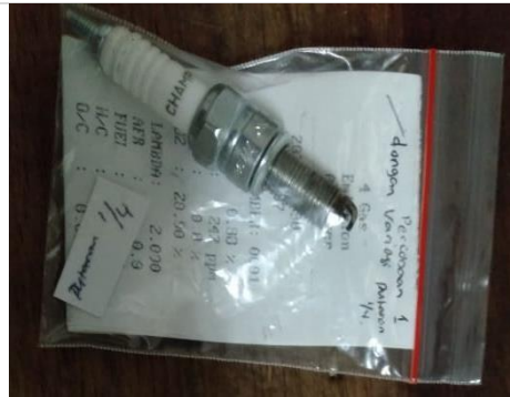
Gambar 4.4 Hasil pembakaran dengan 1/4 putaran air screw
