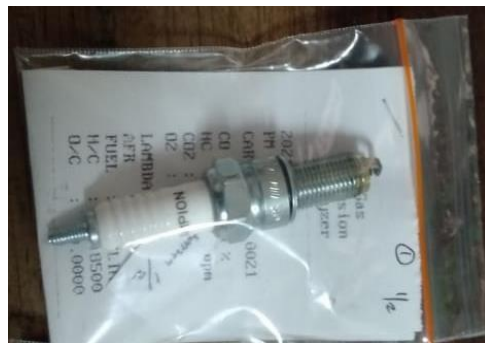
Gambar 4.5 Hasil pembakaran dengan 1/2 putaran air screw
