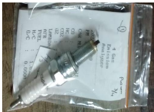
Gambar 4.6 Hasil pembakaran dengan 3/4 putaran air screw
