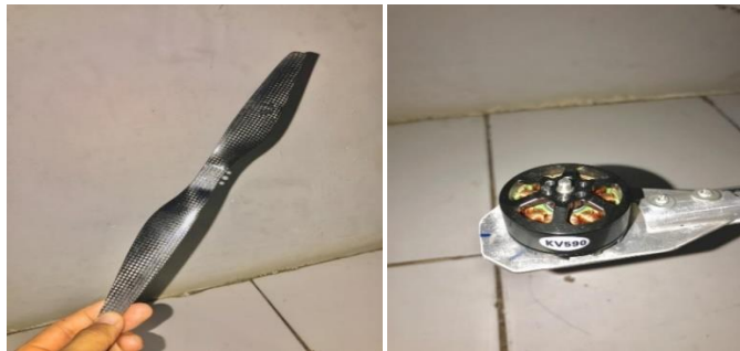
Gambar 2. Motor Brushless 590kv dan Propeller 1255
