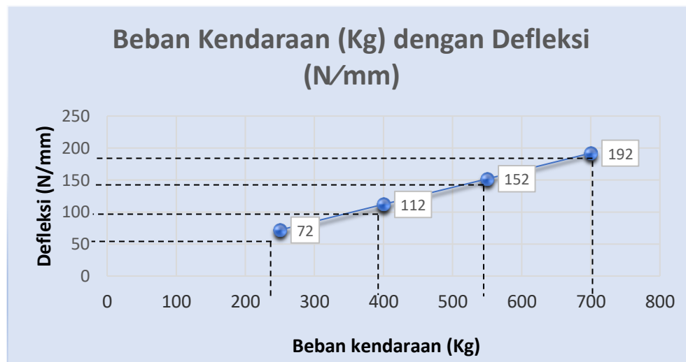
Gambar 4. Hubungan Beban Kendaraan terhadap Defleksi Pegas Daun
