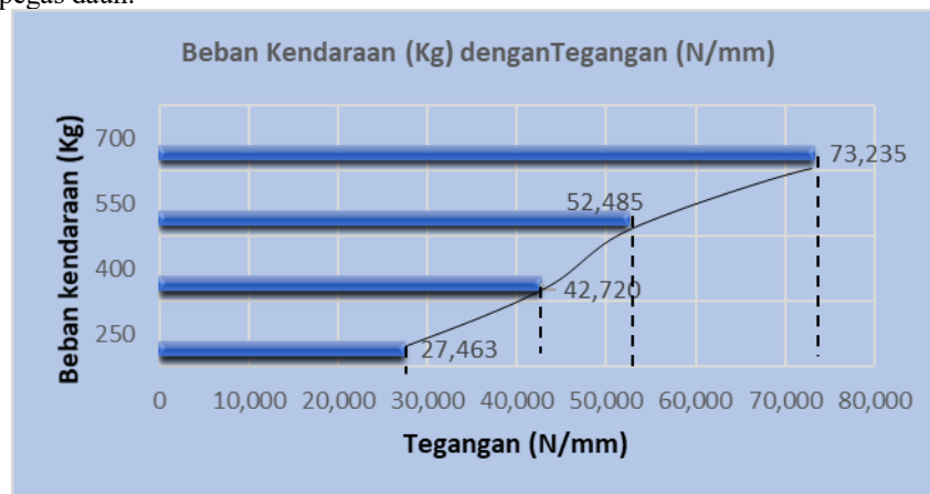
Gambar 3. Hubungan Beban Kendaraan terhadap Tegangan Pegas Daun
