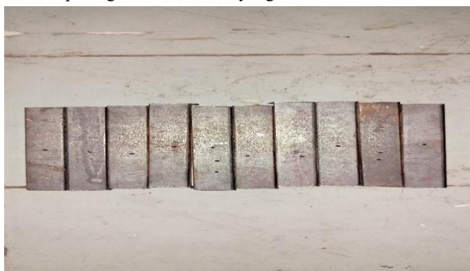
Gambar 5. Benda Uji Setelah Dilakukan Uji Rockwell
