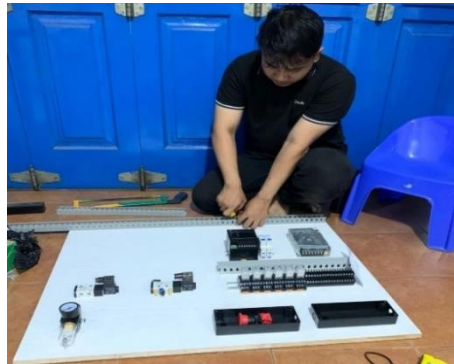
Gambar 12 Proses Perakitan Trainer Pneumatik PLC
