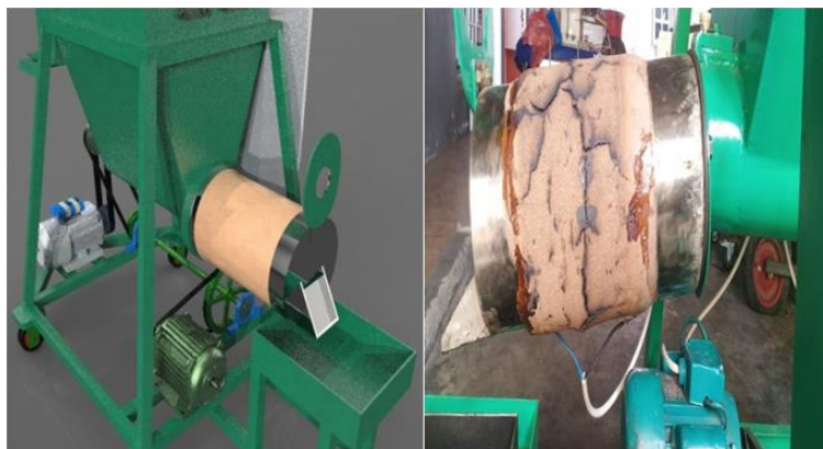
Gambar 3. Perbandingan desain dan implementasi akhir pemanas
