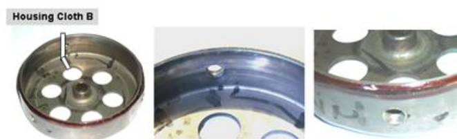
Gambar 8. Photo drum kopling B (baru) dengan membuat lubang pendingin
