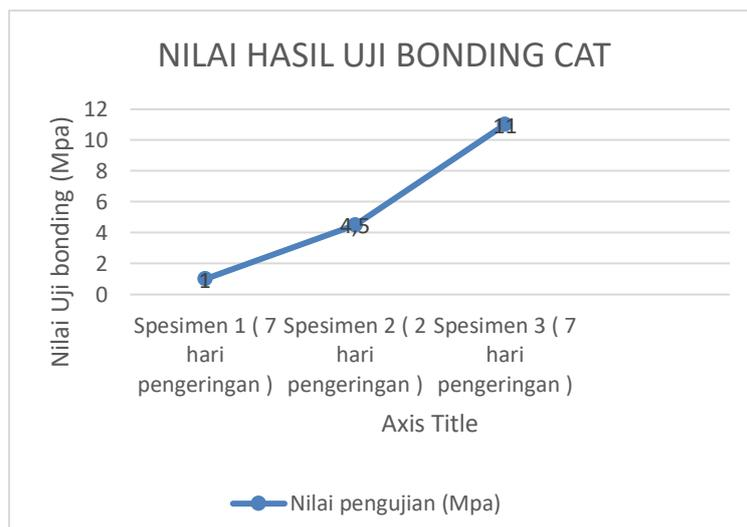
Gambar 13. Nilai Hasil Pengujian Tarik/ Bonding Ke-3 Spesimen
