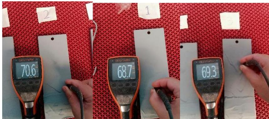
Gambar 7. Pengujian Ketebalan Cat Saat Kering ke-3 Spesimen
