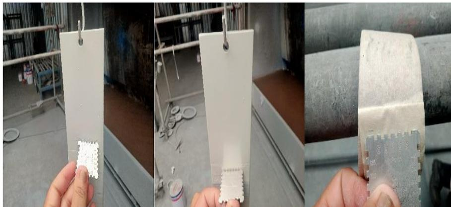
Gambar 8. Pengukuran Ketebalan Basah Pada ke-3 Spesimen
