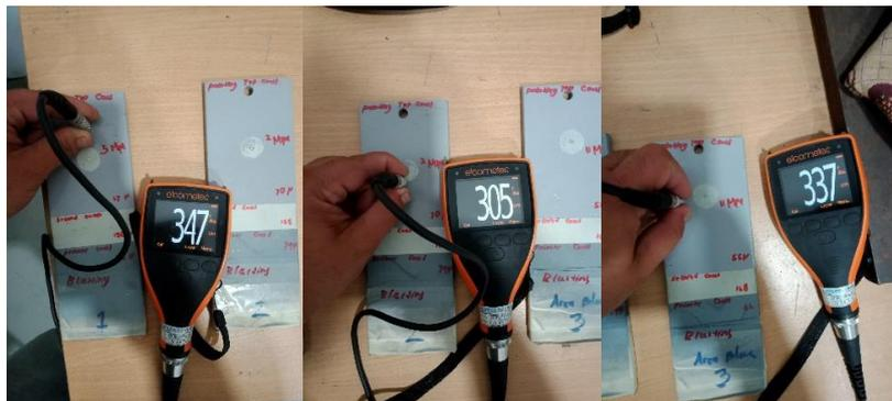
Gambar 10. Pengujian Ketebalan Cat Saat Kering
