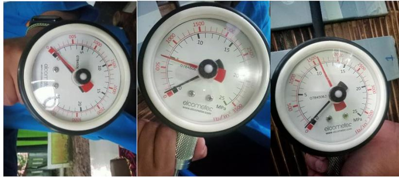
Gambar 12. Hasil Nilai Uji Tarik atau Uji Bonding
