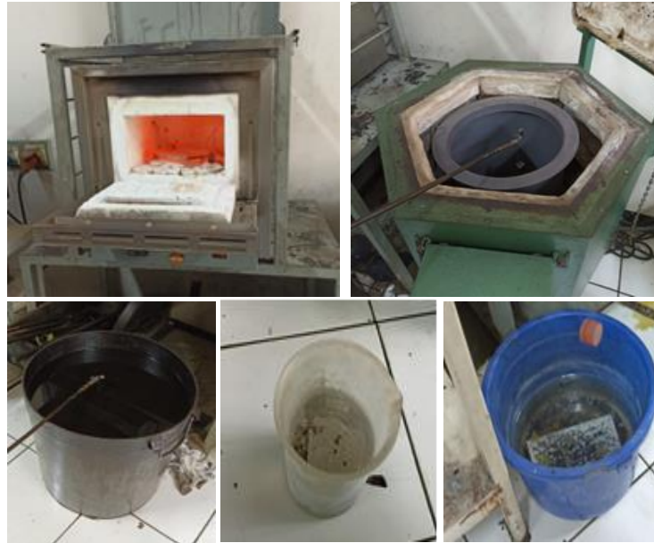
Gambar 3. Peralatan yang Digunakan Dalam Penelitian (atas: tungku pemanas, bawah: oli, air garam dan air)
