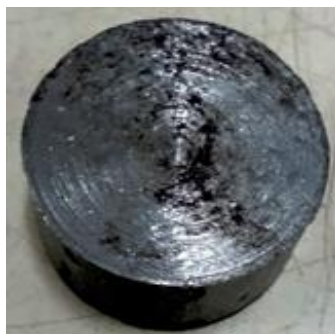
Gambar 2. Baja ST60 Sebagai Sampel pada Penelitian
