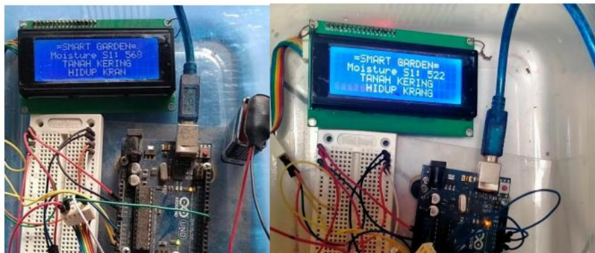
Gambar 10. Hasil Pengujian Sistem: Tanah Kering
