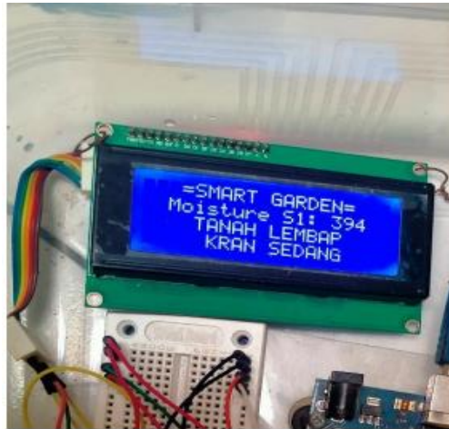
Gambar 9. Hasil Pengujian Sistem: Tanah Lembab
