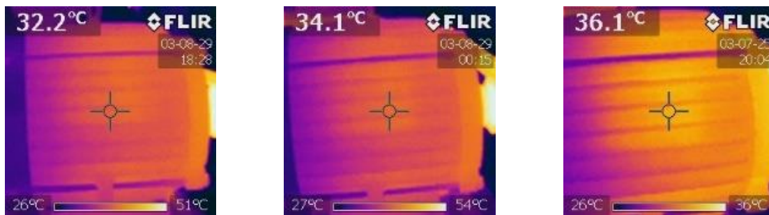
Gambar 5. Penyebaran Temperatur pada Motor Body pada Pemindaian 120 Menit Dengan Pembebanan Fully Open , 20°, dan 40°
