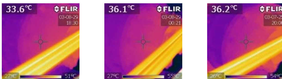
Gambar 15. Penyebaran Temperatur pada BCDE1 pada Pemindaian 120 Menit Dengan Pembebanan Fully Open , 20°, dan 40°
