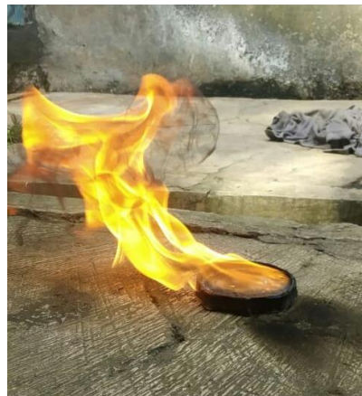
Gambar 5. Uji Bakar Minyak Hasil Pirolisis
